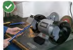
EQUIPOS EN BUEN ESTADO Y CON GUARDAS
