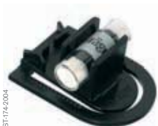
Dräger diffusion sampler ORSA
